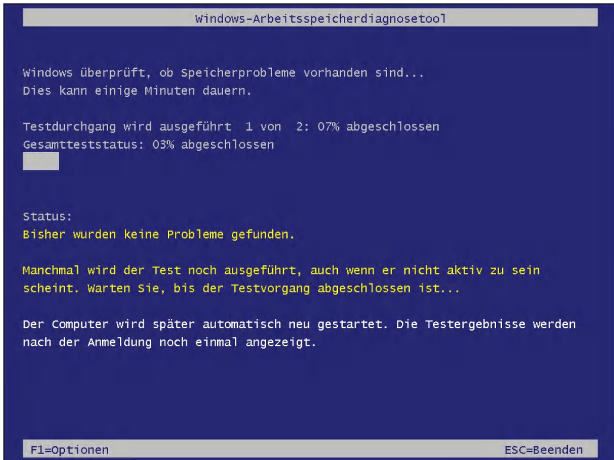
Abbildung 21.3: Mit »mdsched« können Sie den Betriebszustand des Arbeitsspeichers prüfen.
